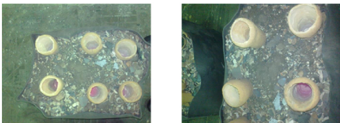
Рисунок 2 – Фото керамических оболочек с использованием в составе огнеупорной обсыпки прокаленного формовочного песка
