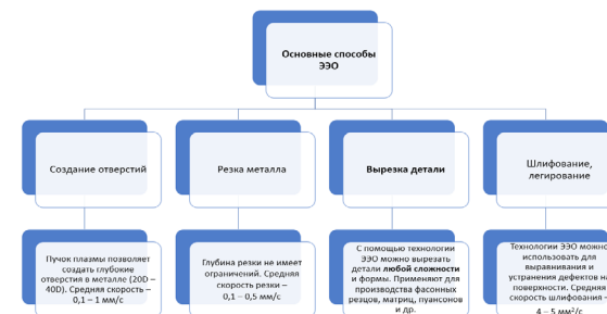
Рисунок 1 – Способы электроэрозионной обработки
