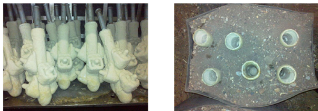
Рисунок 3 – Фото моделей и керамических оболочек с использованием в составе огнеупорной суспензии порошка борной кислоты
