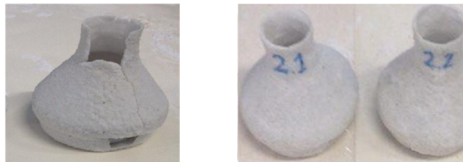
Рисунок 5 – Опытные образцы экспериментальных образцов оболочковых форм после выплавления модельного состава: а) с кристаллическим кварцем, б) с плавленным кварцем
