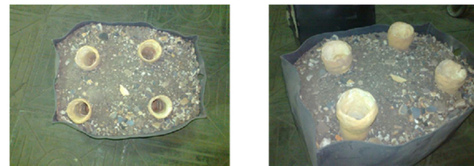
Рисунок 1 – Фото керамических оболочек: размещение в опоке меньшего количества форм с большей толщиной наполнителя между оболочками
