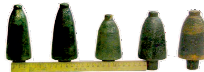
Рисунок 2 – Оправки прошивного стана различной калибровки диаметрами, мм: а – 48; б – 51; в – 53; с – 56; д – 58
