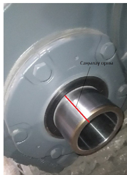
Сурет 3 – Кранның козғалу редукторының арнайы саңылауы
